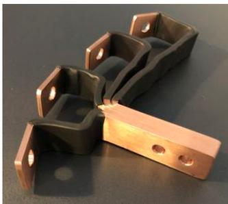
Le jeu de barre présent sur la photo est fait de 4 éléments de 4mm par 20 mm calculez le courant électrique maximum acceptable sachant que la densité de courant électrique autorisé est de 15 ampères par  $\text{mm}^2$
